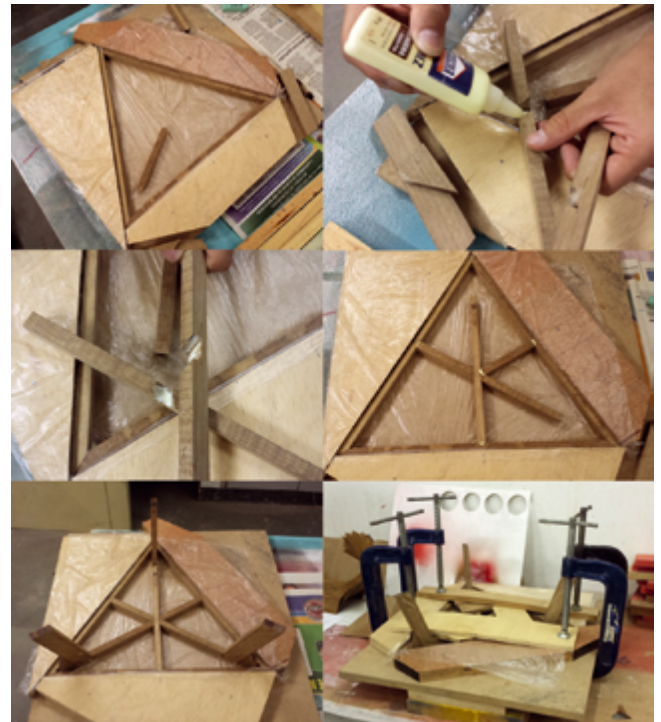
Figura 10: Colagem da estrutura da mesa.
