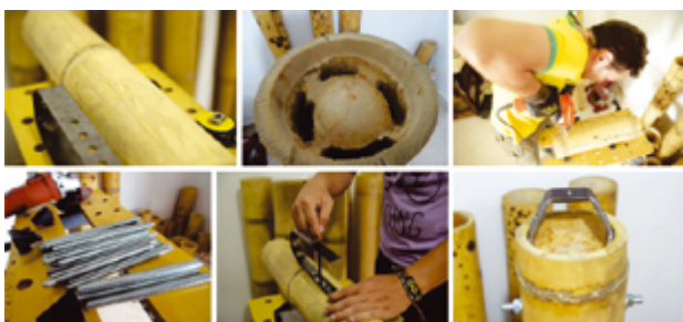
Figura 04. Processo de montagem do terminal no colmo de Guadua
