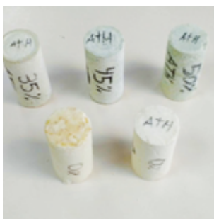
Figura 3: Corpos de prova de PU, PU/ATH e PU/ATH/PET utilizados para os testes de isolamento térmico e de resistência mecânica.
