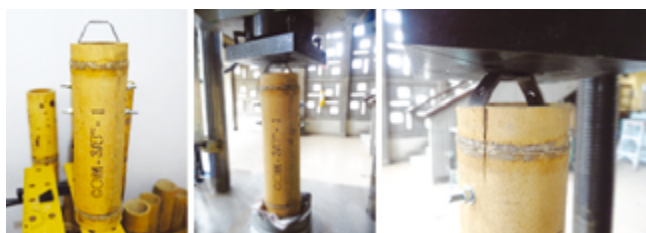
Figura 08. Procedimento do ensaio de compressão no corpo de prova COM – 3/8" – L.
