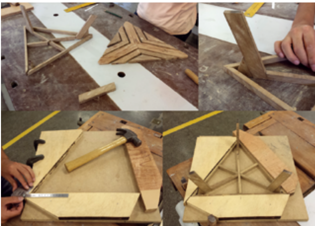
Figura 9: Pré-montagem do modelo; construção do gabarito de madeira para estabilizar as peças durante a colagem.
