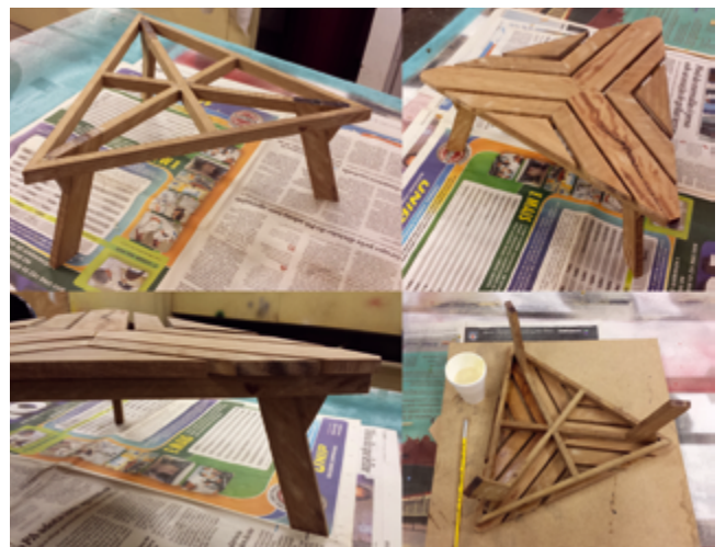
Figura 11: Finalização do processo de colagem da mesa (tampo); para o acabamento, houve a aplicação de verniz marítimo acetinado a base d'água.
