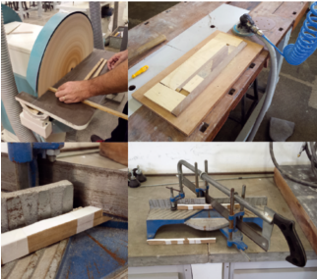
Figura 8: Refinamento com lixadeira circular e manual; nivelamento com lixadeira roto orbital pneumática; corte angulado dos encaixes com a serra de arco.
