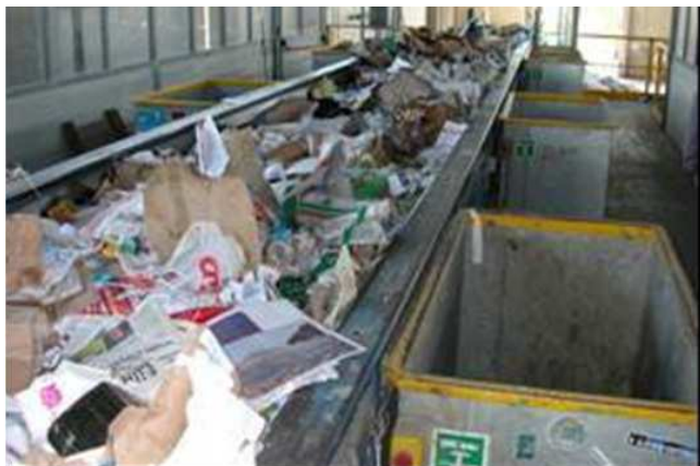
Figura 7: Separação de papel e papelão: é feita manualmente por tipo de material, sendo este colocado nas aberturas, caindo em esteiras para posterior empacotamento.eletrodomésticos, na 'Ilha Ecológica.
