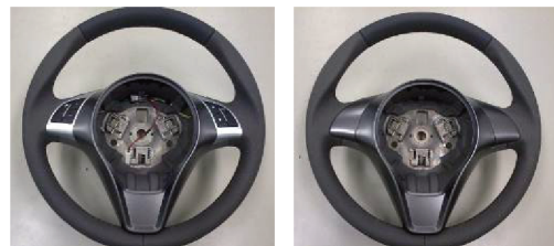
Figura 5: Volantes em couro com comando rádio no volante e sem comando.
