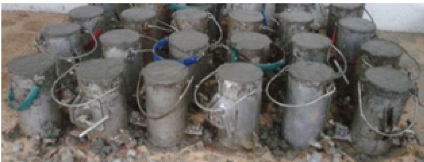
Figura 1 - Moldagem dos corpos-de-prova
