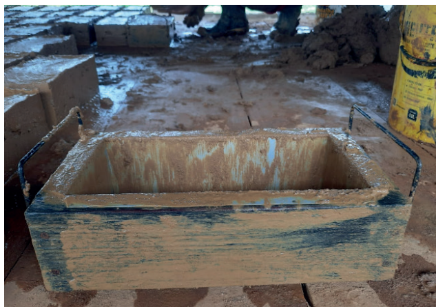
Figura 04: Forma confeccionada para produção do adobe no Assentamento João Amazonas. Fonte: Acervo pessoal dos autores (2023).
