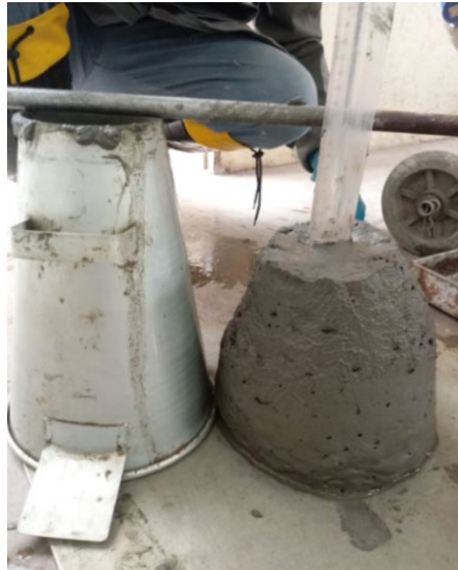
Figura 02: Ensaio de consistência pelo abatimento do tronco de cone do T.R. Fonte: autores.
