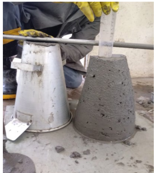
Figura 03: Ensaio de consistência pelo abatimento do tronco de cone do C6. Fonte: autores.
