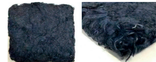
Figura 4: Placa composta por fibra de denim. Fonte: NAVACERRADA et al., 2021
