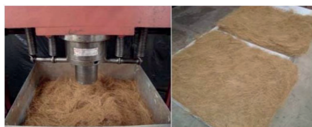
Figura 1: a) Formação das camadas de fibras de açaí; b) Painéis de fibra de açaí. Fonte: BASTOS et al., 2021.
