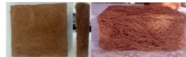
Figura 2: Painel de fibra de coco minimamente processada. Fonte: ARAUJO et al., 2015
