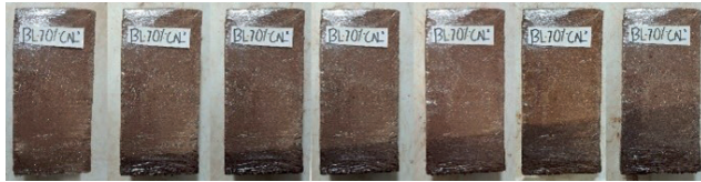
Figura 04: Sequência fotográfica do processo de ascensão capilar da água no mesmo adobe. Fonte: Autoras.
