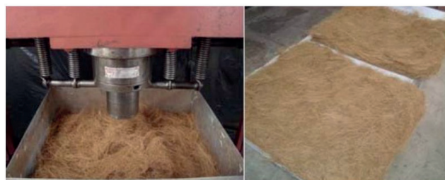
Figura 1: a) Formação das camadas de fibras de açai; b) Painéis de fibra de açai. Fonte: BASTOS et al., 2021.
