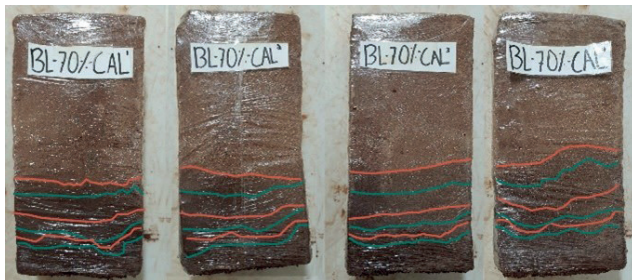
Figura 05: Sequência fotográfica do processo de ascensão capilar da água em uma mistura de adobe. Fonte: Autoras.
