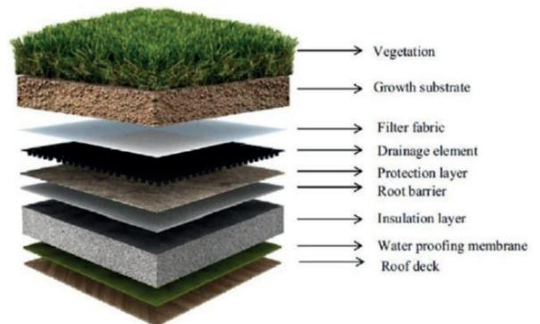
**Figura 5:** Principais componentes de uma cobertura verde.
