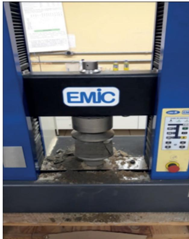
**Figura 2a:** Prensa EMIC para teste de rompimento.
