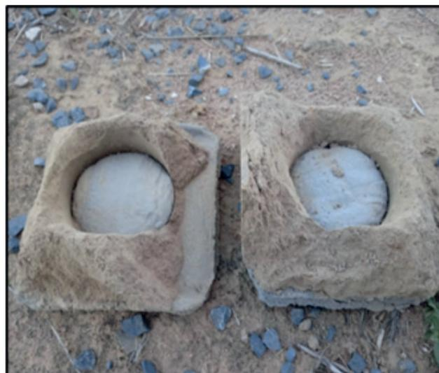
**Figura 2b:** Bloco de solo-cimento posterior ao teste de rompimento.
