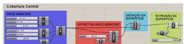
**Figura 17:** Programação da modelagem de uma das superfícies de cobertura da atividade de projeto.
