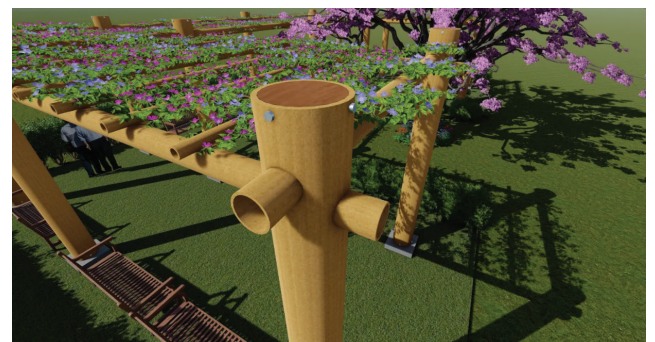
Figura 16 – Detalhe da perfuração e transpasse dos tubos de papelão e da bolacha de madeira parafusada no topo. Fonte: As autoras.
