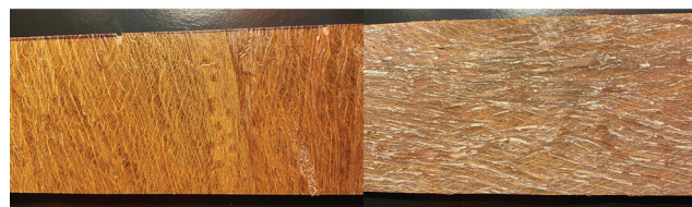
Figura 10: Diferença entre os dois lados do compósito. Fonte: Autores.
