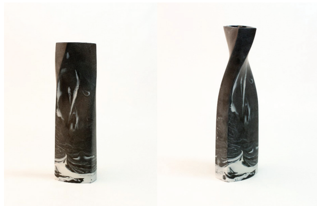
Figura 5 – Pormenor do contraste cromático resultante de uma pasta negra de porcelana obtida pela incorporação de resíduos na sua composição, (empresa Vista Alegre).
