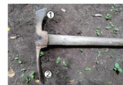
PICARETA: Possui duas "cabeças", (1) serve para cavar terrenos duros, fazer buracos e vala. (2) mais pontiagudo, tem função principal de arrancar e quebrar pedras. Seu principal uso é nos roçados, cavando buracos, retirando pedras, tocos de árvores e raízes grossas.
