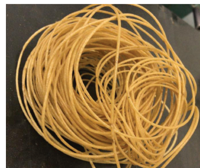
Figura 04: Filamento PLA10M de madeira produzido. Fonte: Autores.
