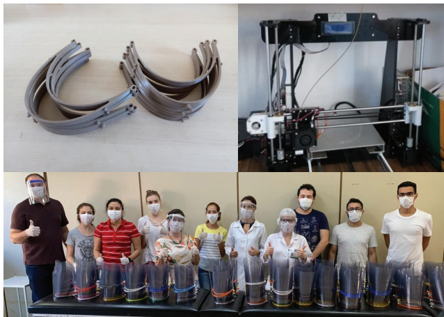
Figura 2: Suportes para face shields (a) produzidos utilizando impressão 3D FFM (b) e montados por equipe de colaboradores do hospital (c).
