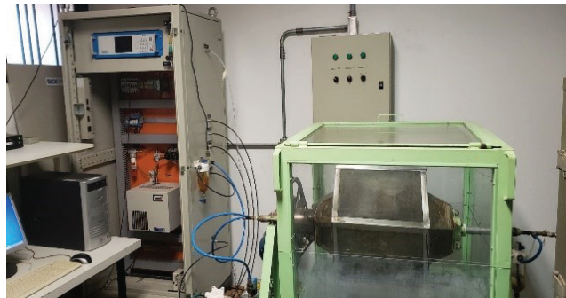
Figura 1 - Estrutura do processo de experimentos de compostagem formada basicamente por: tambor rotativo, analisador de gases e aquisição de dados
