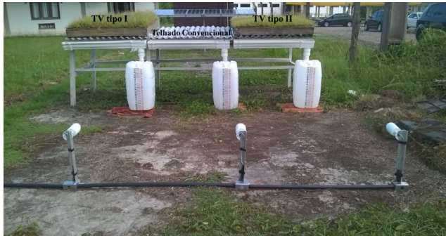
Figura 4 - Vista frontal dos três telhados verdes com monitoramento por câmeras Fonte: Autores
