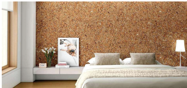
Figura 03 – Revestimento interno de painéis de cortiça Fonte: OMA, 2020
