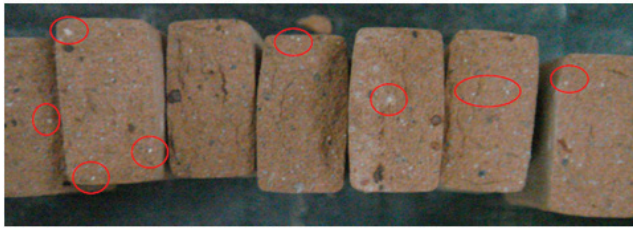
Figura 06 – Partículas metálicas presentes nos corpos de prova pela presença de pontuações escuras Fonte: Cardoso (2009)
