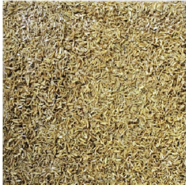
Figura 05 – Painel isolante de casca de arroz Fonte: BURATTI et al., 2018
