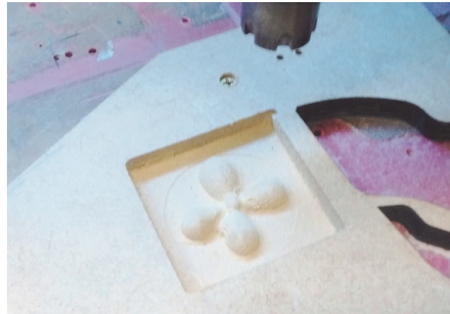
Figura 03 – Processo de usinagem em madeira da peça criada Fonte: Autores
