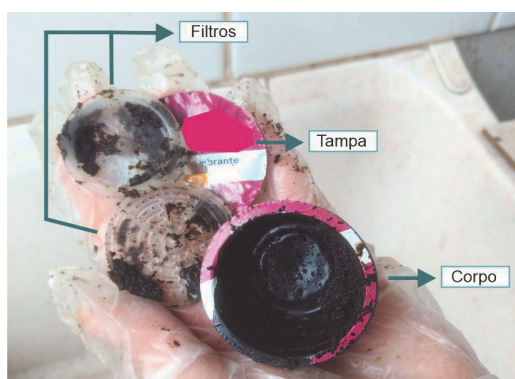
Figura 01 – Partes da cápsula de café da Marca A Fonte: Autores
