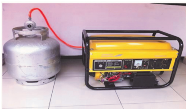
Figura 1 - Gerador de eletricidade a gás Fonte: Alvarenga, (2015)
