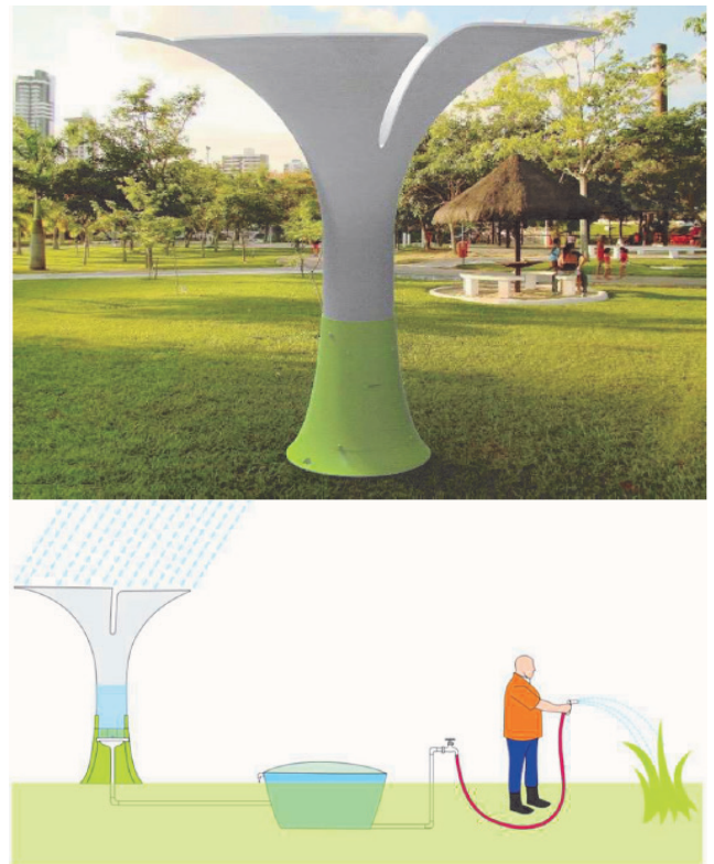
Figura 01 - Equipamento para captação de água da chuva em parques urbanos. Fonte: Silva (2014).
