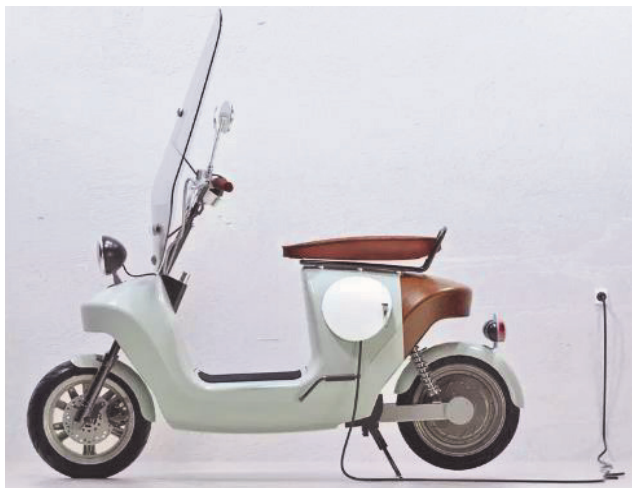
Figura 12 - Conceito de scooter fabricada em compósitos de fibras vegetais Fonte: Waarmaker, 2013
