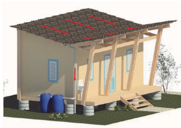
**Figura 20** – Sistema de reaproveitamento de água das chuvas
