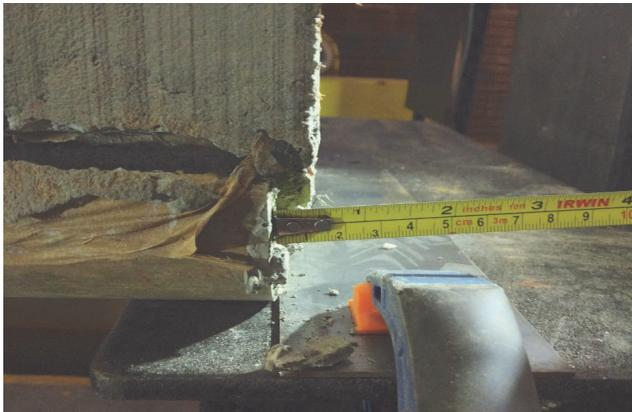
**Figura 13** - Ilustração do deslocamento da laje 05
