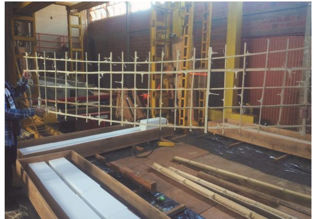
Figura 04 - Malha de filetes de bambu, amarradas com barbante de sisal
