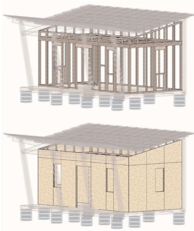
**Figura 15** – Estrutura das paredes em sistema *wood frame* e fechamentos em placas de OSB
