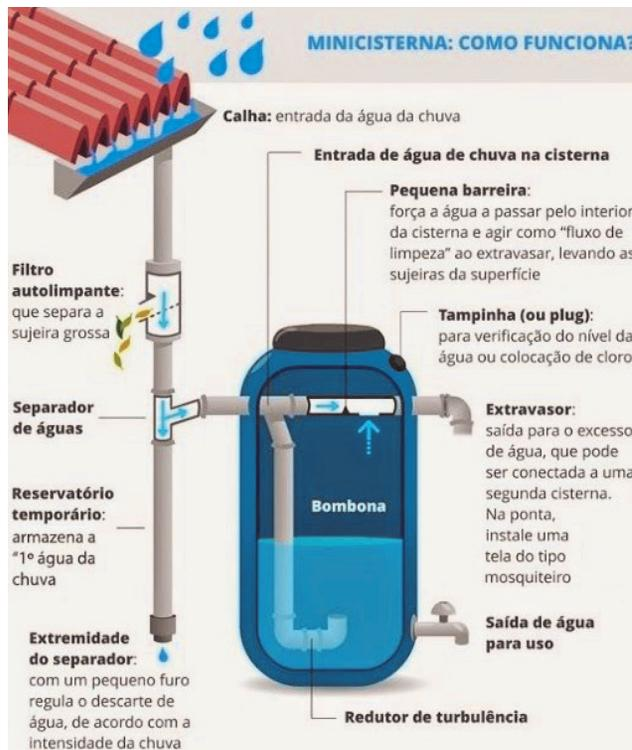
Figura 21 – Esquema de funcionamento da mini cisterna
