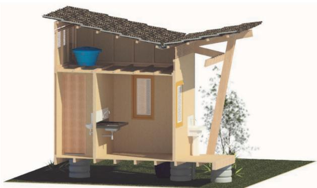
**Figura 18** – Corte perspectivado com instalação de caixa d'água no entreforro
