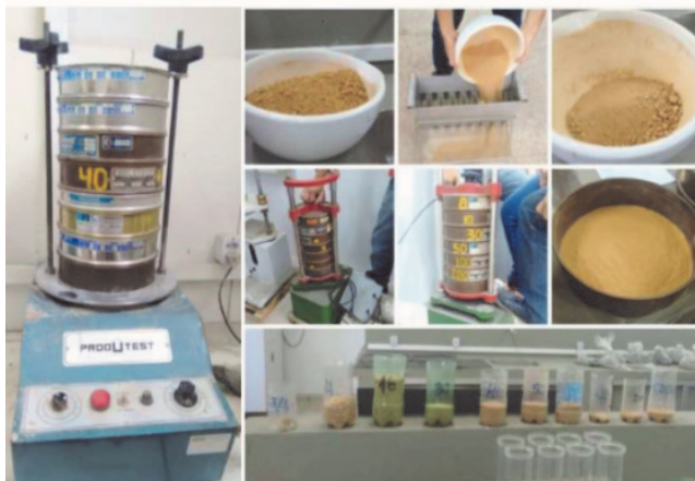
Figura 6 - Ensaio de peneiramento - série de peneiras padronizadas e aparelho elétrico de peneiramento. Fonte: Autora (2018).
