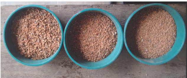
Figura 3 - Granulometria do RCD. Fonte: Acervo da Autora (2018)
