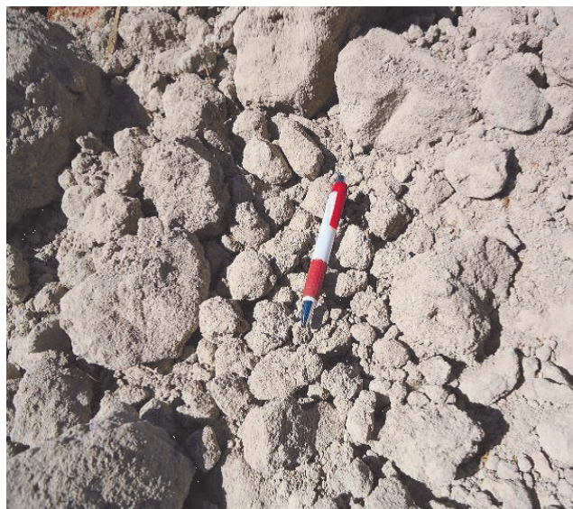
Figura 1 – Resíduo de argamassa de cimento e areia coletado em canteiro de obra Fonte: Autora
