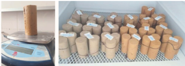
Figura 2 - Pesagem dos corpos de prova pós-estufa. Fonte: Autora (2018).
