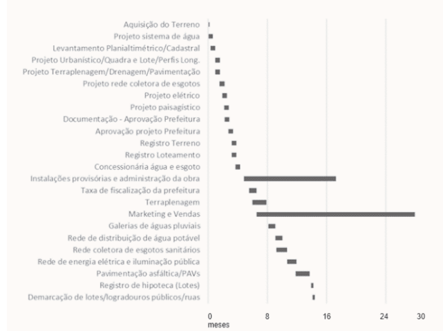
Figura 03 - Diagrama de Gantt para as etapas do processo de loteamento Fonte: Autores.
