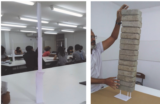
Figura 01 e 02 – Estruturas confeccionadas com uma folha A3 (75g) e 50 cm de fita adesiva Fonte: Autores (2018).
