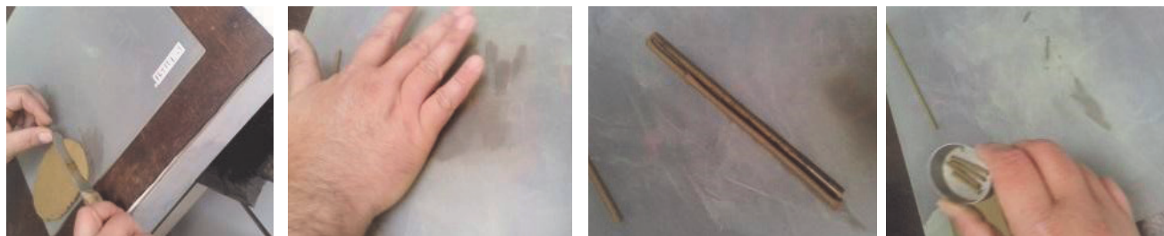
Figura 07 – Sequência fotográfica do ensaio de plasticidade realizado em empresa privada Fonte: Lisboa, 2019
