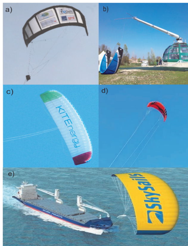
Figura 08 - Protótipos com aerofólios cabeados em modo de sustentação. Fonte: a) KitePower (VLUGT et al., 2014), b) KiteGen (KITEGEN, 2016), c) KitEnergy (KITENERGY, 2018) d) UFSCkite (LELLIS et al., 2016) e e) SKYSAILS (SKYSAILS, 2014).
