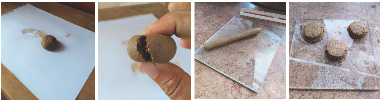
Figura 06 – Ensaios de campo: queda de bola (superior esquerda), cordão (superior esquerda), fita (inferior esquerda) e resistência seca (inferior direita) Fonte: Autores, 2019
