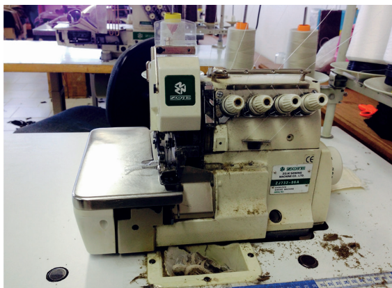
Figure02 – Desenvolvimento da segunda costura – Interlock Sewing Machine Fonte: Author.
