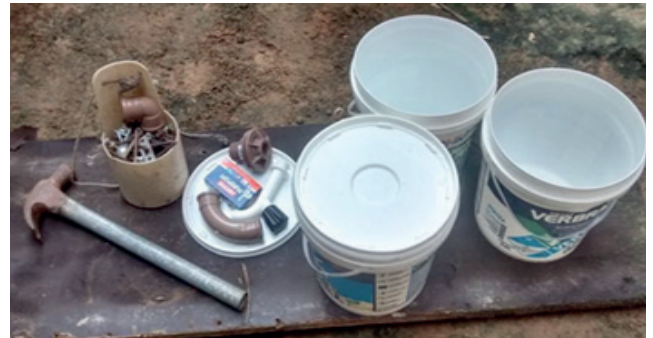
Figura 01 – Materiais utilizados na fabricação da composteira Fonte: Dados da pesquisa, 2019.
