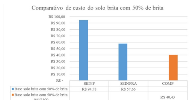
Figura 10 – Comparativo do custo unitário do solo brita e da jazida natural Fonte: Autor, 2019.
