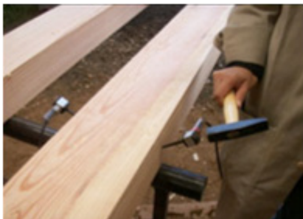
Figura 5 – Ensaio de propagação de ondas aplicado em viga de madeira Fonte: Sotomayor e Ramírez, 2015.
