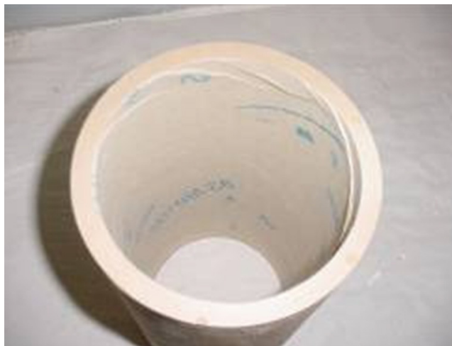
Figura 7 – Ondulações formadas no corpo-de-prova Fonte: Salado (2006).
