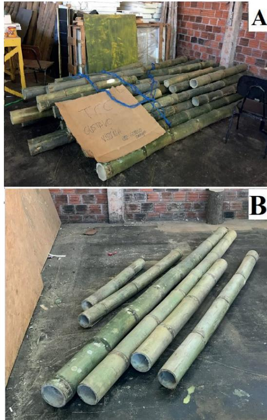
Figura 11 – Secagem das barras de bambu
