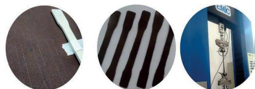
**Figura 05** – Corte dos corpos de teste e execução do teste de tração. Máquina utilizada no teste: Emic Célula: Trd 23 Data: 27/09/2017 Fora:14:27:48 Trabalho nº:1088. Programa: Teso Versão 3.84 Método de Ensaio ASTM D638 Tensão de Ruptura Sem Extensômetro.
