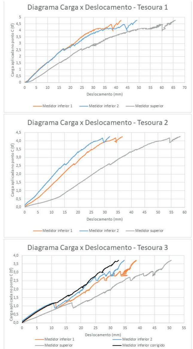
Figura 20 – Diagrama carga x deslocamento das tesouras 1, 2 e 3
