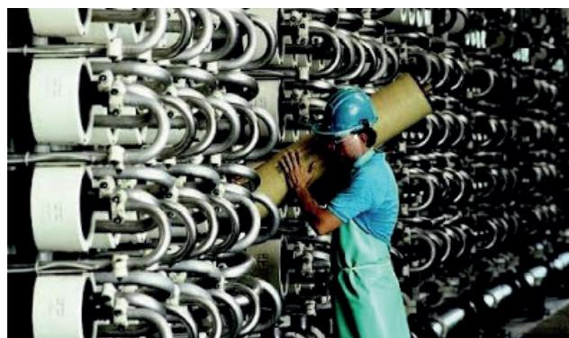
**Figura 09** – Usina de dessalinização por osmose reversa.
