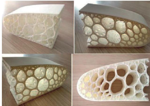
**Figura 02** – Impressão 3D como exemplo de aplicação de uma estrutura bioinspirada nas estratégias de leveza e resistência do agave. Estrutura que pode ser emulada em uma ampla gama de artefatos (ARAÚJO, 2015).
