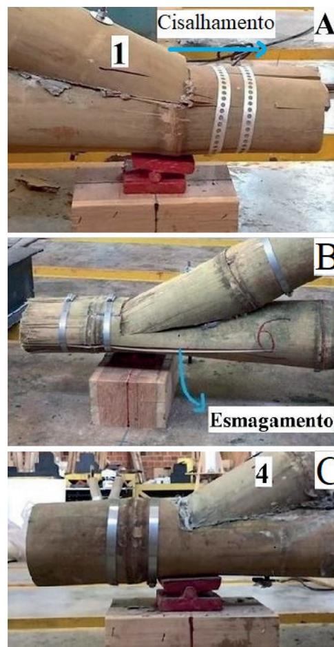
Figura 22 – Três situações distintas capturadas na iminência da ruptura
