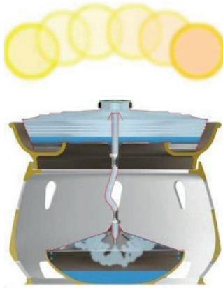
**Figura 11** – Esquema da destilação solar.
