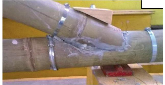
**Figura 8** – Reforço de ligação com abraçadeira metálica
