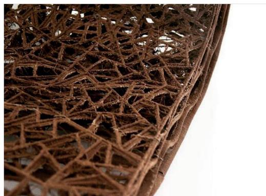
Figura 07 – Estrutura bioinspirada impressa em 3D com filamento de madeira.
