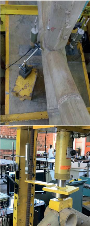
**Figura 18** – Disposição dos sensores de deslocamento nas tesouras
