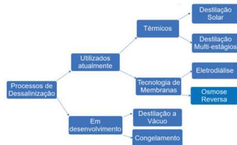
Figura 02 – Fluxograma dos tipos de Dessalinizadores.
