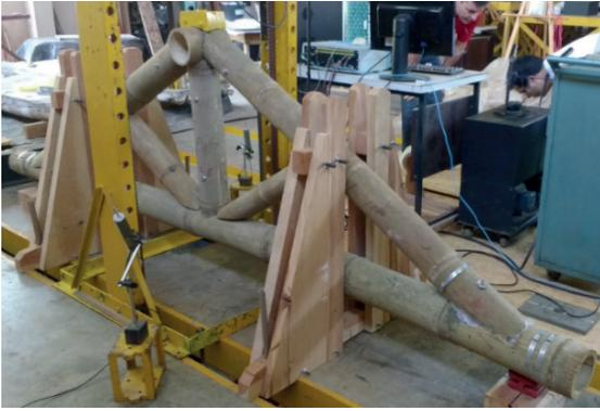
**Figura 17** – Tesoura posicionada no pórtico para realização do ensaio
