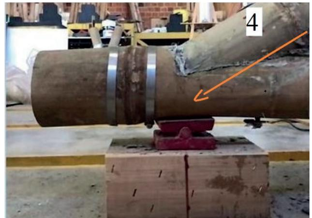
Figura 23 – Alinhamento do banzo superior com o apoio
