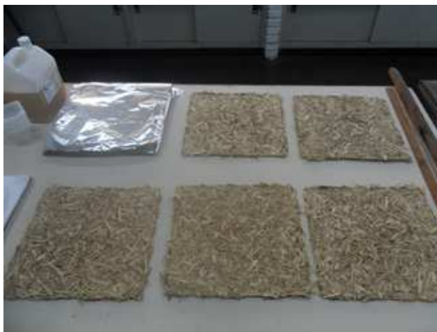
Figura 10 - Preparación del colchón con partículas de Gynerium sagittatum .
