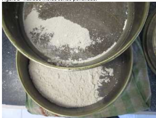
Figura 2 - Resíduo moído sendo peneirado.
