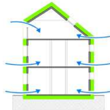
Figura 03 - Insolação sobre as aberturas no inverno e no verão.
