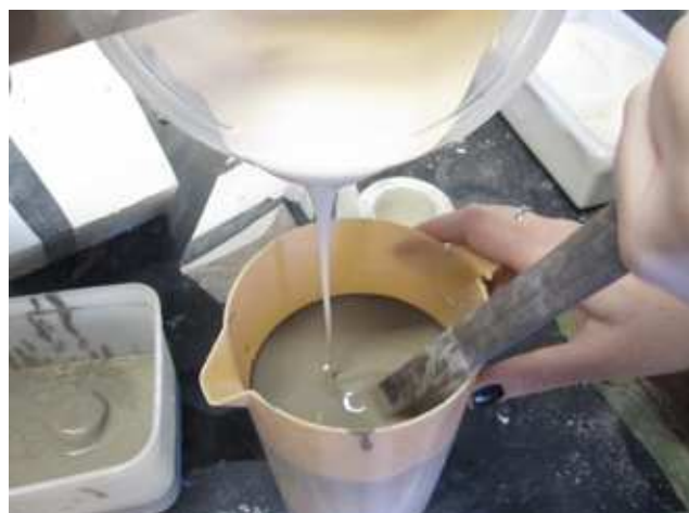
Figura 3 - Resíduo moído sendo adicionado à massa cerâmica pura.
