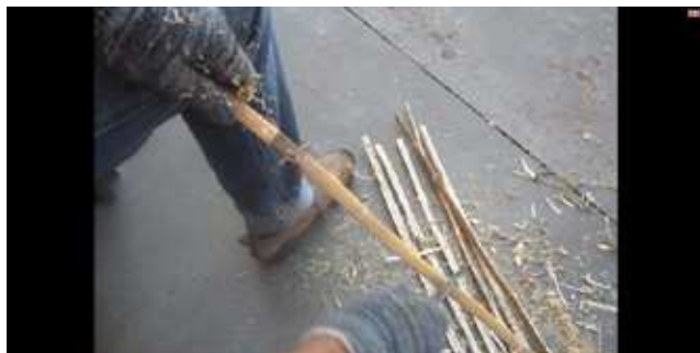
Figura 05 – “Raspado” manual de la tira de Gynerium sagittatum .
