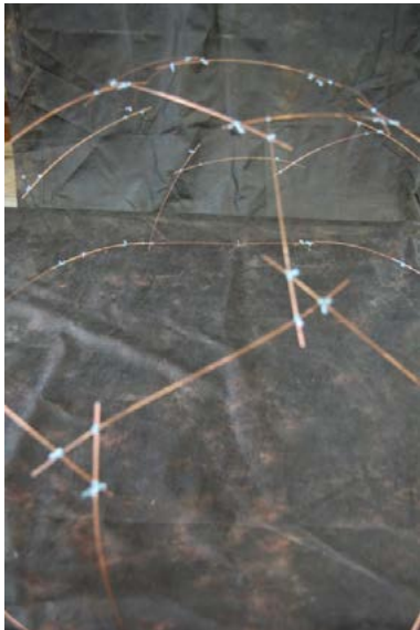
Figura 14: Geodésica feita de barras de aço de 1mm de diâmetro e colapso da estrutura com recipiente vazio
