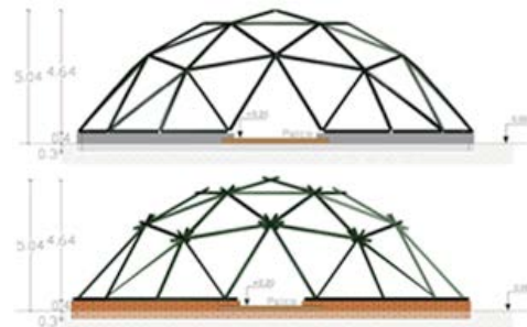
Figura 03 – Fundação Domo Geodésico I (Pedra Argamassada) e II (Tijolo maciço argamassado)
