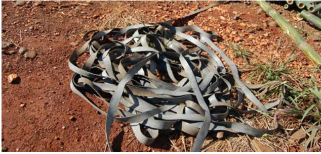
Figura 03: Segmentos de colmos de bambu tuldoises selecionados para serem usados na estrutura geodésica.
