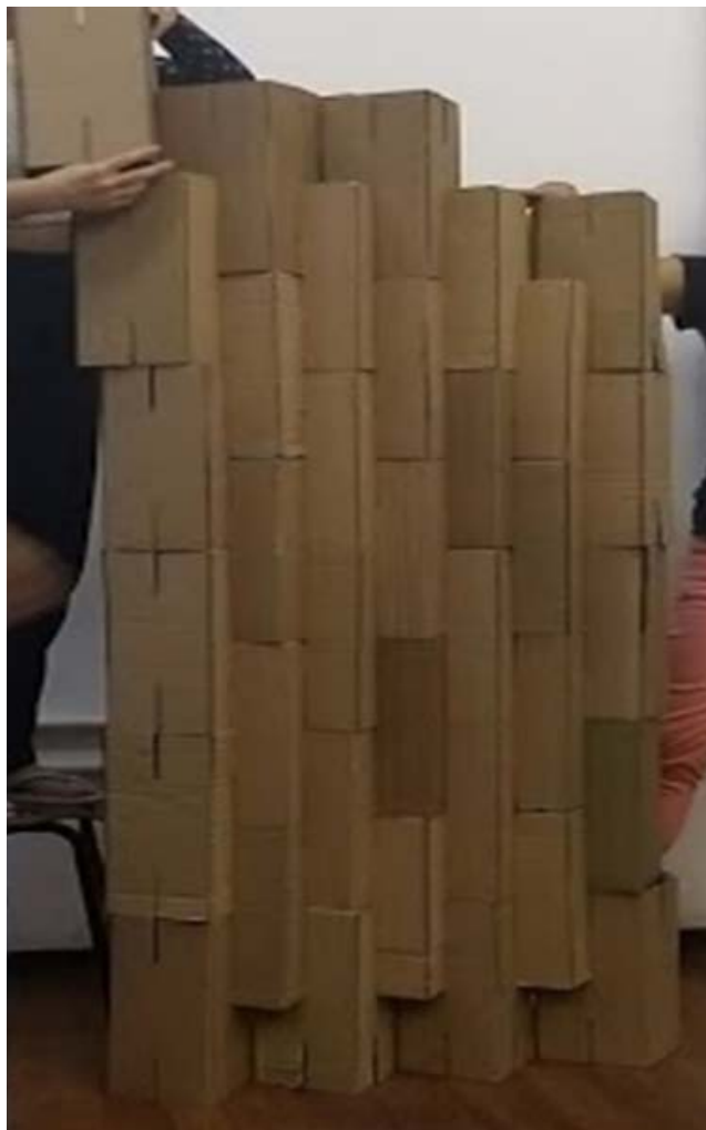
Figura 08 – Fechamento vertical montado
