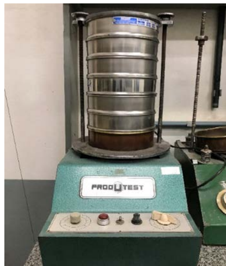
Figura 02: Peneiramento e Classificação da Areia de Desmoldagem
