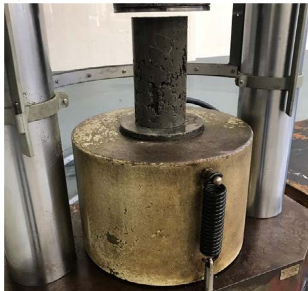
Figura 04: Ensaio de resistência à compressão dos diferentes corpos de prova
