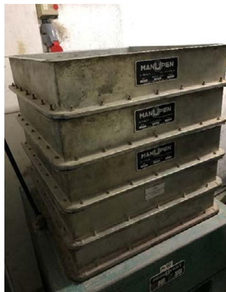
Figura 03: Ensaio de determinação da composição granulométrica brita zero
