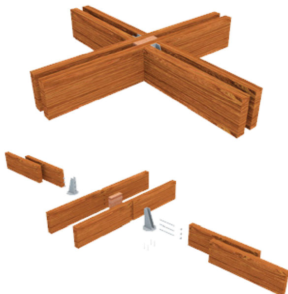
Figura 08 – Interface viga- viga
