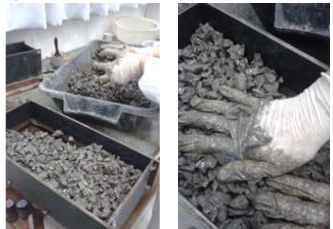
Figura 2 - Mistura dos materiais, e colocação do mesmo na caixa molde.
