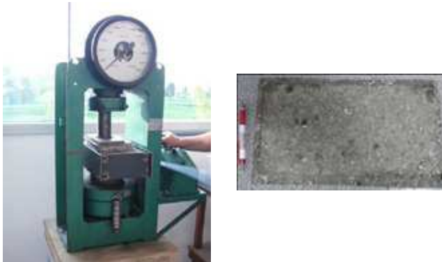
Figura 3 - Aplicação de 5 toneladas e placa pronta após 24 horas.
