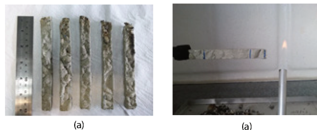
Figura 11 – (a) Ensaio de queima horizontal das amostras de EVA/cimento em execução e (b) resultado final.
