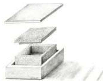
Figura 5 – Sistema caixa EVA/cimento dentro da caixa de concreto com som MP3 dentro.
