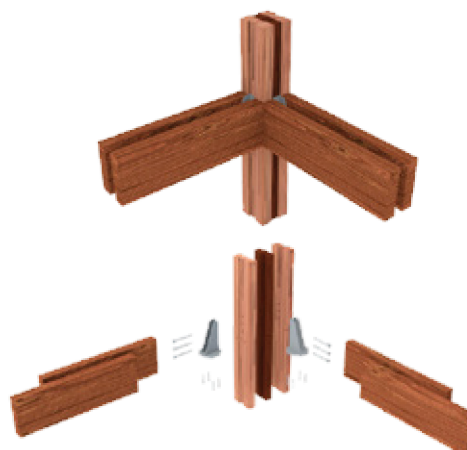
Figura 07 – Interface pilar-2 vigas duplas de canto
