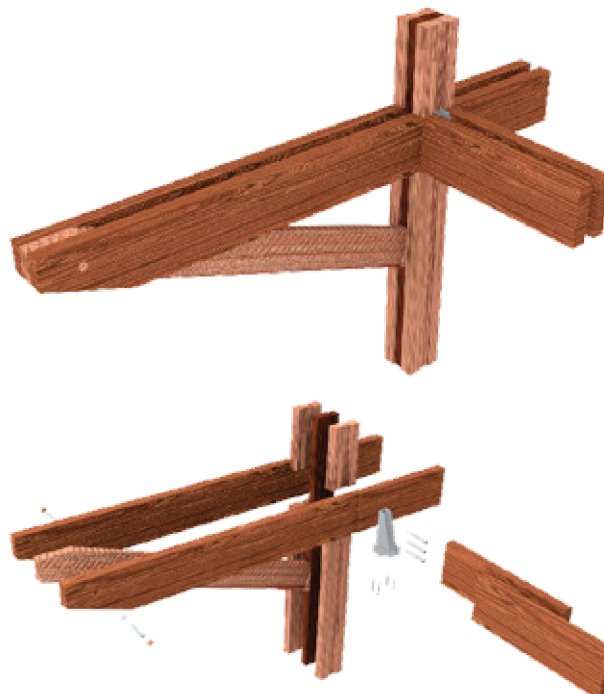
Figura 06 – Interface pilar-2 vigas com mão francesa
