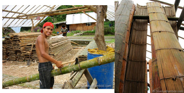
Figura 03 – Trabalhador abrindo colmo manualmente e esterilhas secando ao natural.
