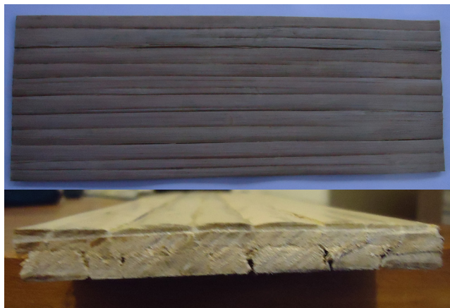
Figura 15 - Placa planificada prensada de bambu tuldoide com duas camadas interposta com fibra, vista superior e de topo.
