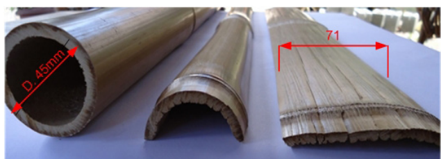
Figura 13– Phyllostachys aurea planificado. Colmo, meio colmo e produto final.
