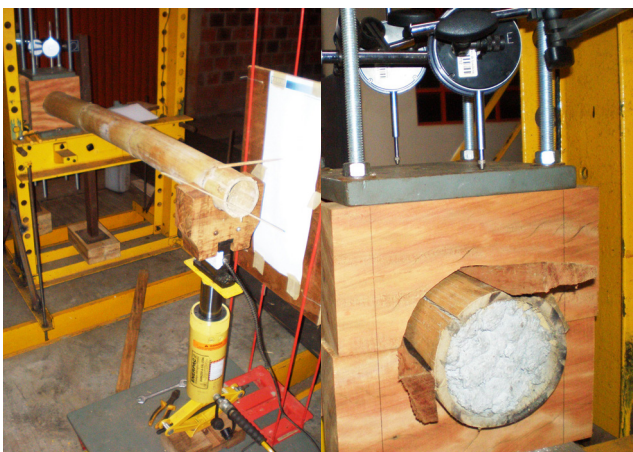
Figura 07: (a) Detalhes do ensaio de flexão para o colmo engastado-livre; (b) Detalhe do primeiro entrenó concretado junto ao engaste
