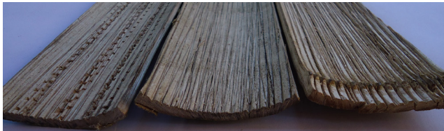
Figura 12– Diferentes tipos de sulcos decorrentes da geometria e ajuste dos rolos
