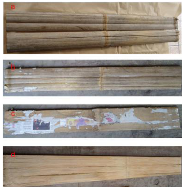
Figura 14– Phyllostachys pubescens em diversas fases do processo. a) Colmo planificado, b) prensado frente, c) prensado verso, d) painel plainado
