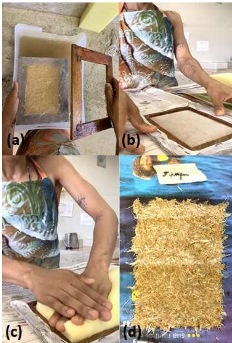
Figura 5 – Confección de las hojas (transferencia y secado)
