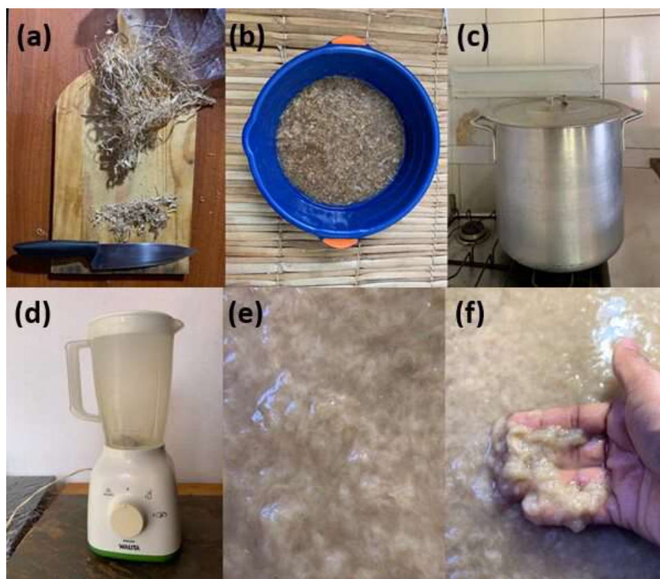
Figura 3 – Procesamiento de la pasta (Protocolo 2)
