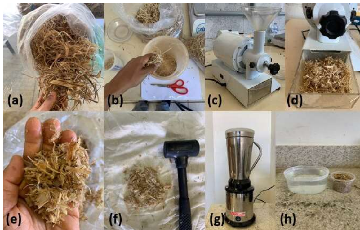
Figura 2 – Procesamiento de la pasta (Protocolo 1)
