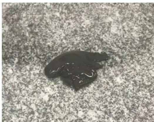
Figure 4: Mini slump result CBA40.
