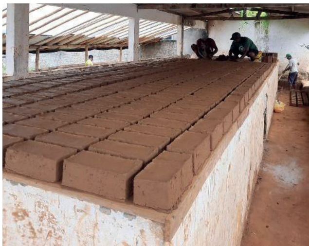
Figura 05: Adobe fabricado pelo Assentamento João. Fonte: Acervo pessoal dos autores (2023).
