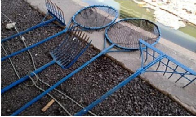
**Figura 07** - Ferramentas utilizadas para as limpezas das Ecobarreiras.
