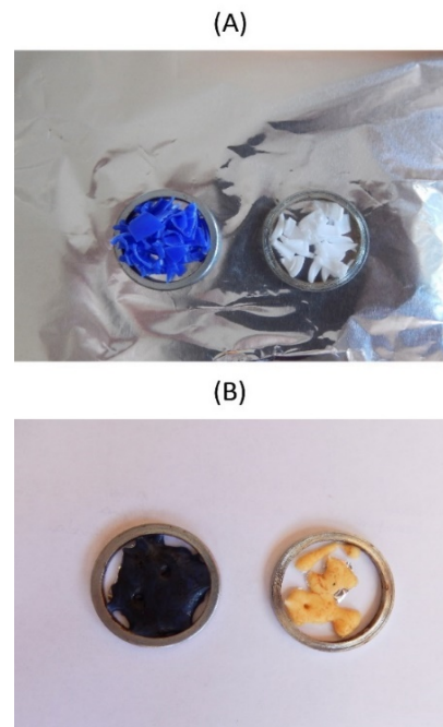
Figura 05 - Teste de forno com PEBD: (A) antes de aquecer e (B) depois do derretimento. Fonte: Autores (2021).
