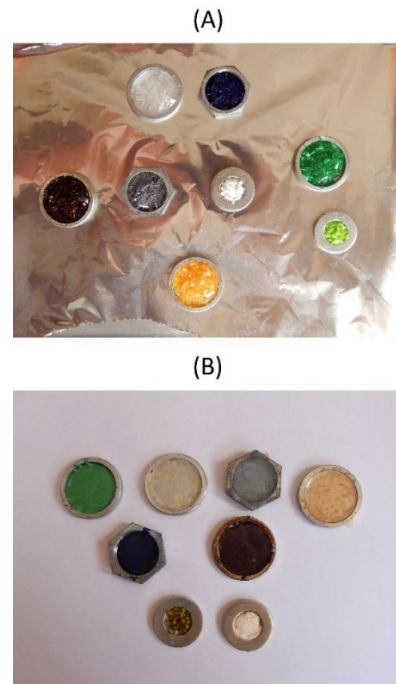
Figura 03 - Teste de forno com PET: (A) antes de aquecer e (B) depois do derretimento. Fonte: Autores (2021).
