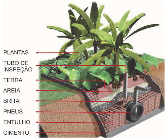
**Figura 19** – Esquema de funcionamento do tanque de evapotranspiração
