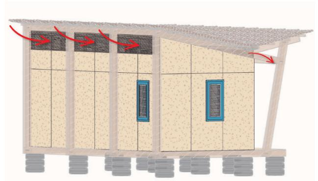
**Figura 16** – Aberturas e esquema de ventilação do entreforro
