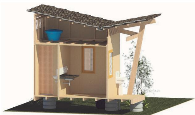
**Figura 18** – Corte perspectivado com instalação de caixa d'água no entreforro
