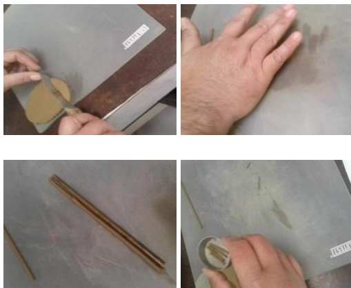
Figura 07 – Sequencia fotográfica do ensaio de plasticidade realizado em empresa privada
