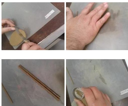
Figura 07 – Ensaio de plasticidade realizado em empresa privada
