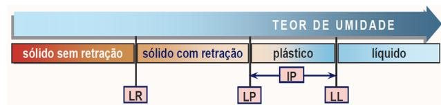
Figura 04 – Estado do solo em função do seu teor de umidade
