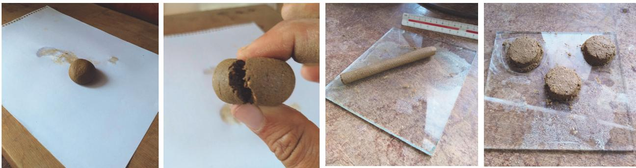
**Figura 06** – Ensaios de campo: queda de bola (superior esquerda), cordão (superior esquerda), fita (inferior esquerda) e resistência seca (inferior direita)
