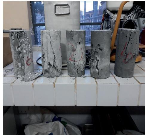
**Figura 1** – Corpos de prova após ensaio de compressão.
