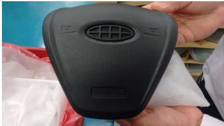
Como ação corretiva do RFMEA a máquina de prensagem passou por reajustes da carga de prensagem, ajustes nos cames de prensagem e colocou-se um feltro na parte de trás do CDA para evitar que a logomarca fosse danificada.
