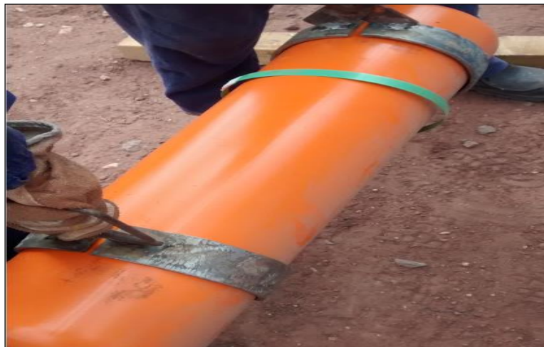
Figura 7 - Dispositivo poka yoke sendo utilizado no ambiente Fonte: A empresa (2017)
