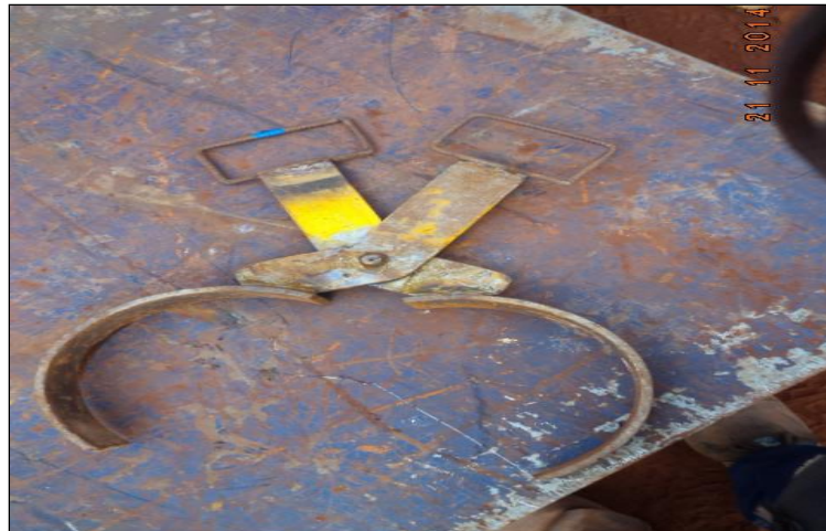
Figura 6 - Dispositivo poka yoke aplicado na atividade de carregamento de rolete Fonte: A empresa (2017)
