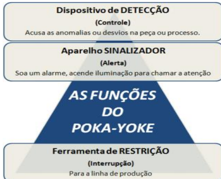
Figura 3 - Classificação de um dispositivo poka-yoke, quanto às funções Fonte: Adaptado de Calarge e Davanso (2003)
