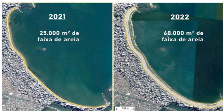
Figura 2. Antes e depois do alargamento da faixa de areia. Fonte: EPAGRI (2023)
