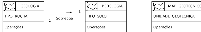
Figura 1. Esquema conceitual para produção do mapa geotécnico preliminar
