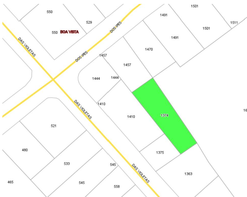
Figura 4. Exemplo de lote encravado. Fonte: SGC (2025)
