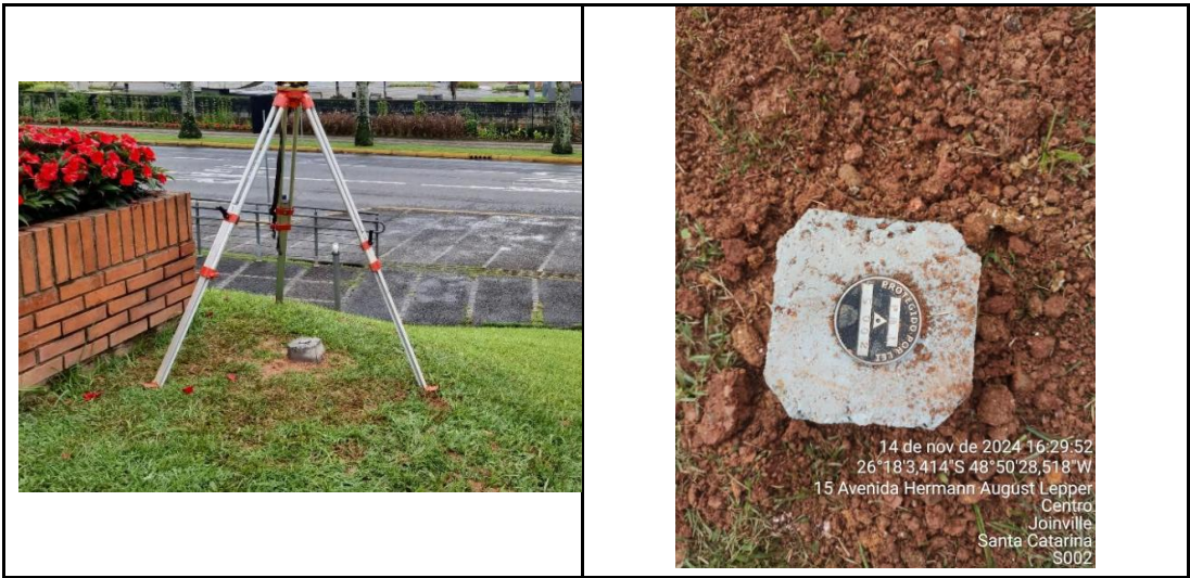
Figura 6. Marco de concreto tronco-piramidal implantado. Fonte - adaptado de Consórcio Nippon Koei Lac - Senografia (2025).
