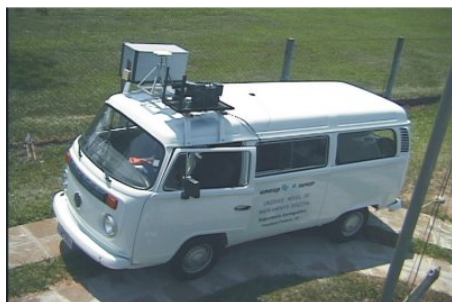
Fig. 1: Unidade Móvel de Mapeamento Digital com as vídeo câmaras digitais e a antena GPS - para ampliar clicar na imagem -
