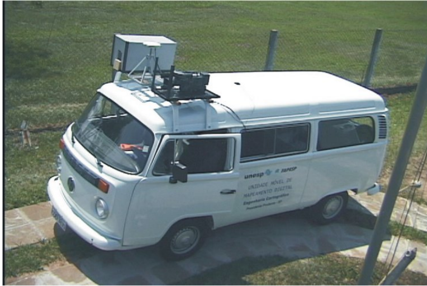
Fig. 1: Unidade Móvel de Mapeamento Digital com as vídeo câmaras digitais e a antena GPS
