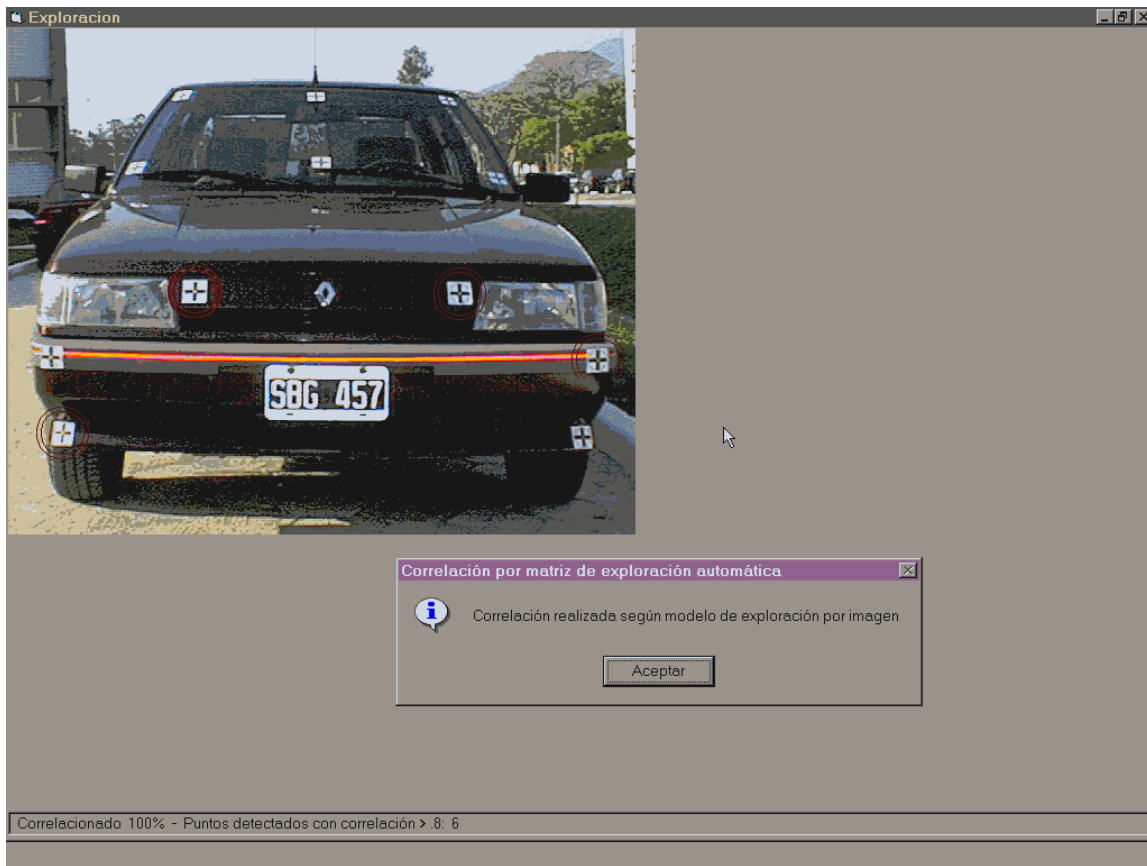
Fig. 17 : Reconhecimento em fotografia digital de sinais coladas em estruturas. As limitações no reconhecimento pela mudança de escala dos sinais não permitiu computar a posição das marcas superiores
