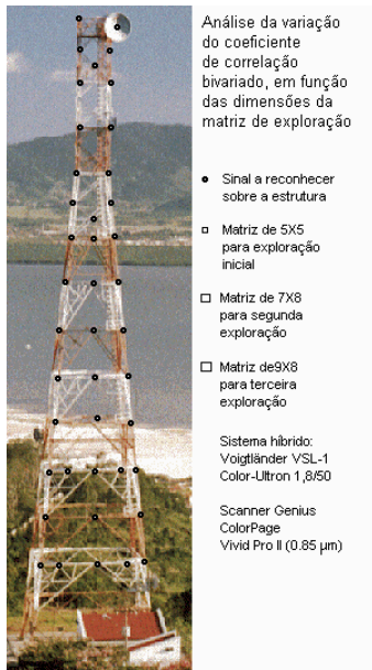
Fig. 25 : Modelo utilizado para estudar a variação do coeficiente bivariado na correlação digital de imagens
