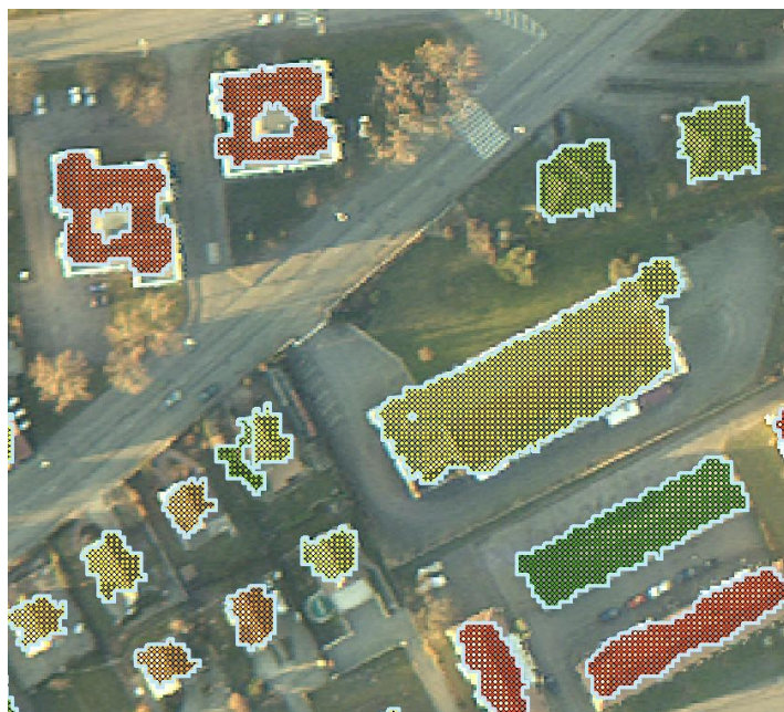
Fig.1: Segmentação de prédios em 3D na municipalidade de Bourtzwiller/Alsacia (Franca) para a estimativa de consumo de energia.
