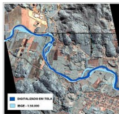
Figura 9: Comparação entre a digitalização em tela – escala 1:3.000 e fonte cartográfica digital do IBGE – qualidade 1:50.000
