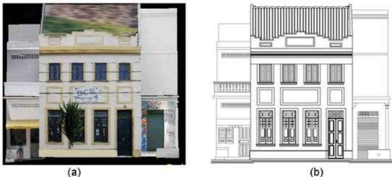
figura 10: (a) Ortofoto da fachada principal do criada no PhotoModeler; (b) Desenho obtido no AutoCAD a partir do traçado das características da fachada sobre a ortofoto.
