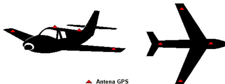
Figura 6: Posições das antenas GPS (Adaptada de Galo, 2003)
