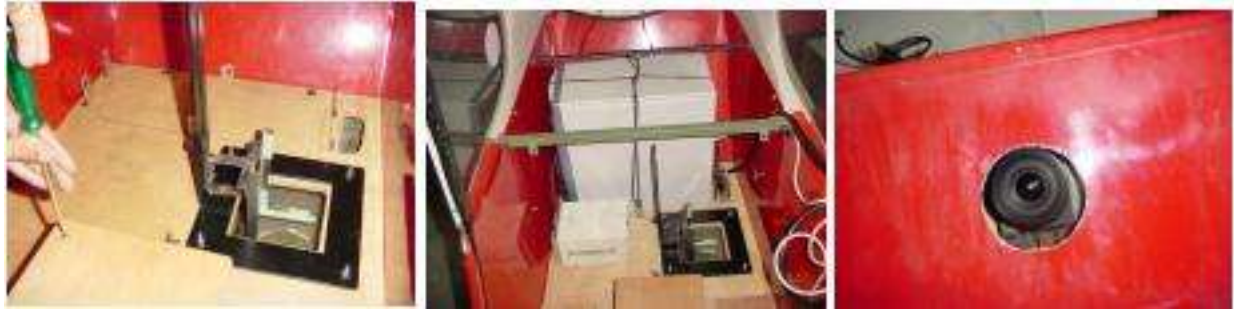
Figura 5 : Suporte e furo no piso da aeronave para instalar a câmara.
