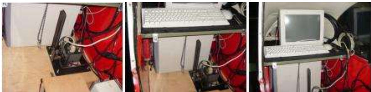
Figura 6 : Sistema de aquisição montado no Cessna PA-18.
