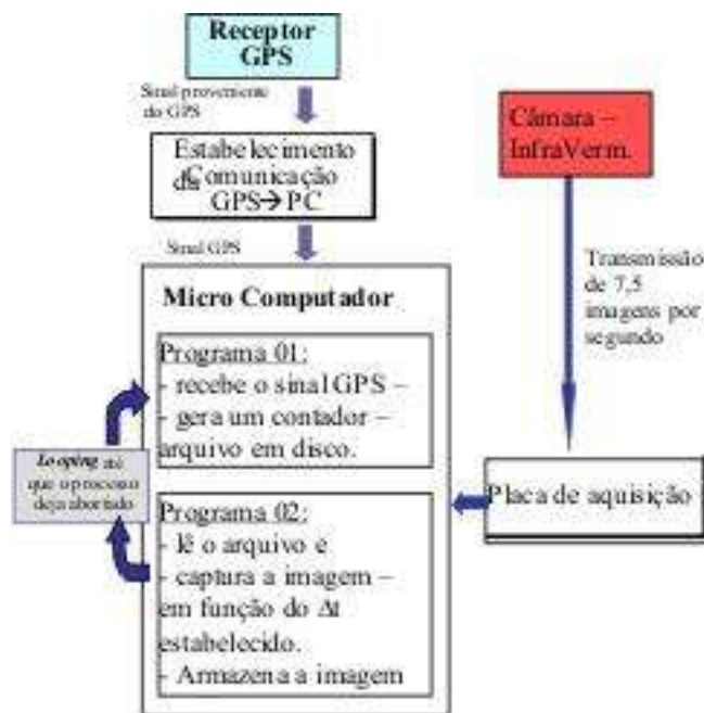
Figura 8 : Fluxograma do processo de aquisição de imagens georreferenciadas.
