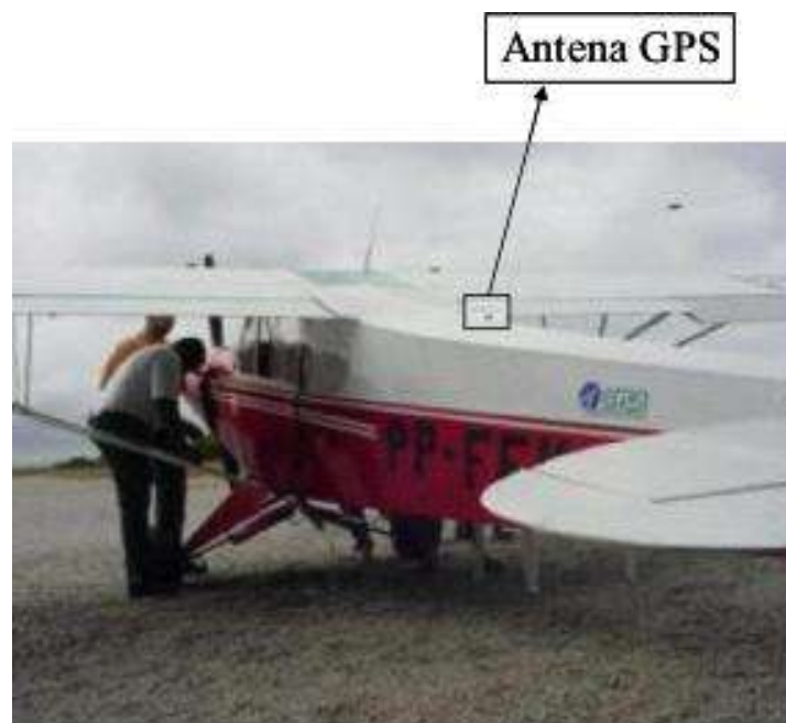
Figura 7 : Posição da antena GPS no teto da aeronave.
