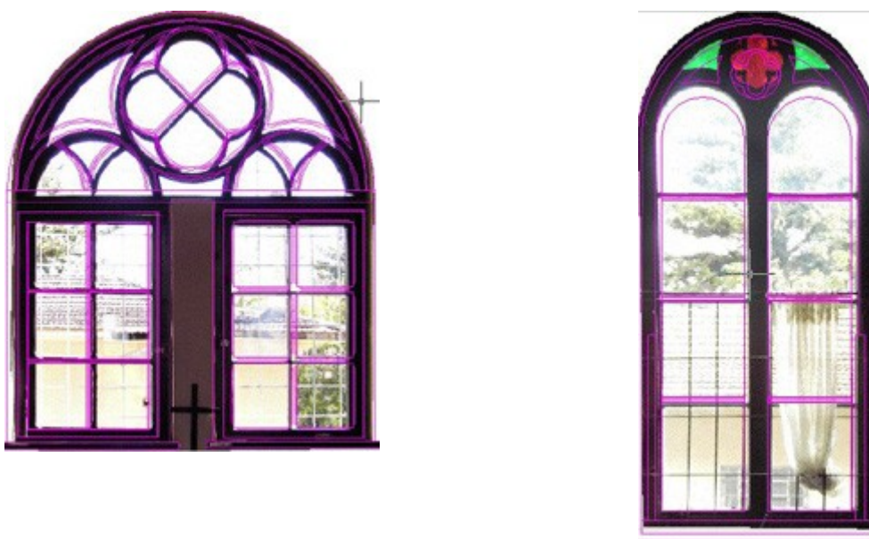
Fig. 7 – Fotografias das janelas sobrepostas sobre o levantamento e documentação gráfica realizada pela equipe de arquitetos para a realização do projeto de restauro. Fig. a – janela do altar . Fig.b – janela da nave. Fonte: Acervo próprio, 2006.
