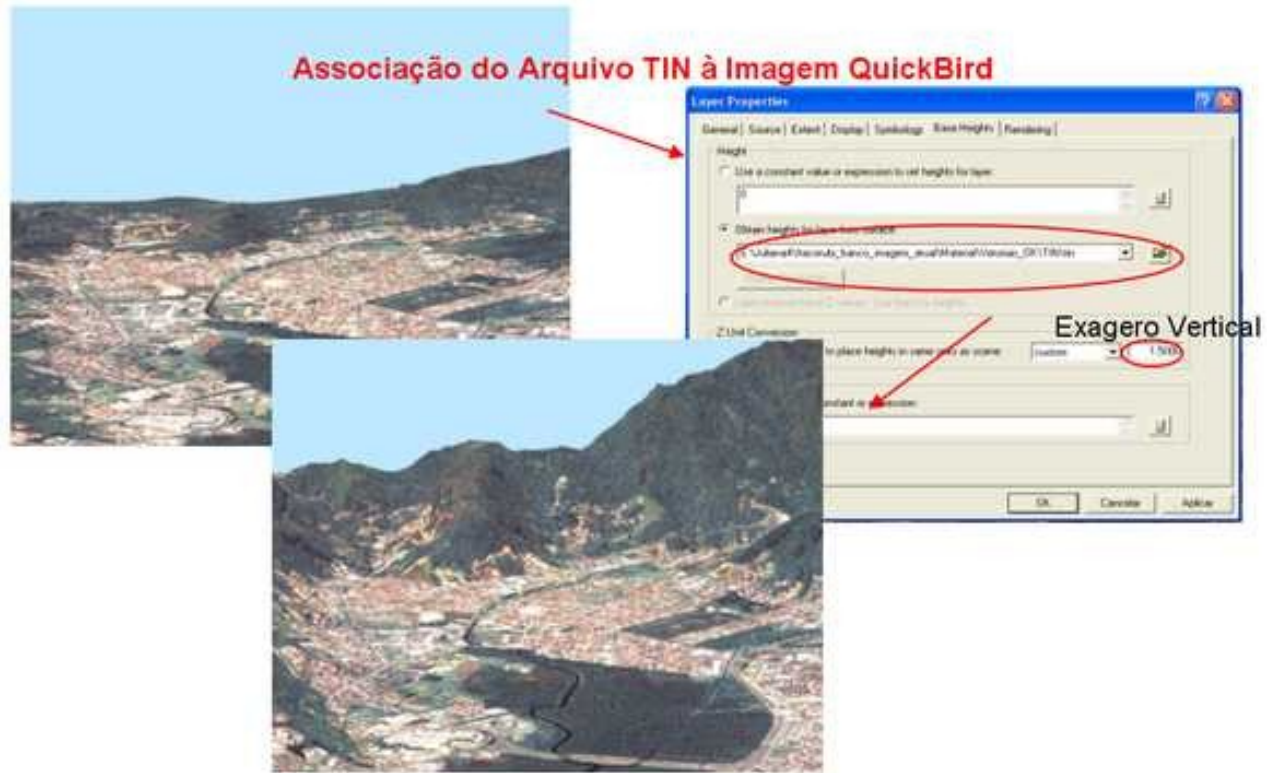
FIGURA 03: Representação da Associação da Imagem QuickBird ao TIN, para visualização em 3D.
