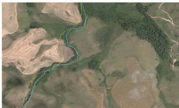
Figura 9: Linhas determinadas por carta topográfica, por GPS e pela imagem.
