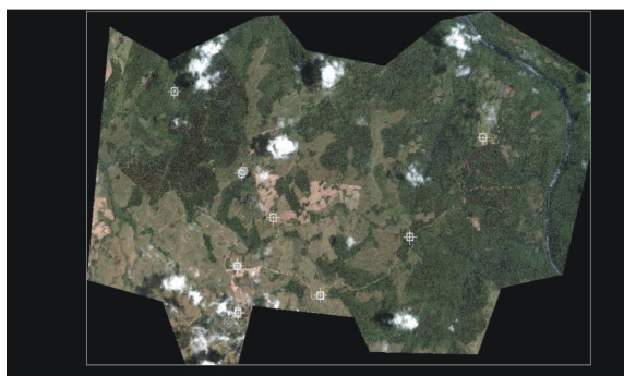
Figura 2 : Os pontos de controle distribuídos em toda a extensão da imagem, determinados por GPS.
