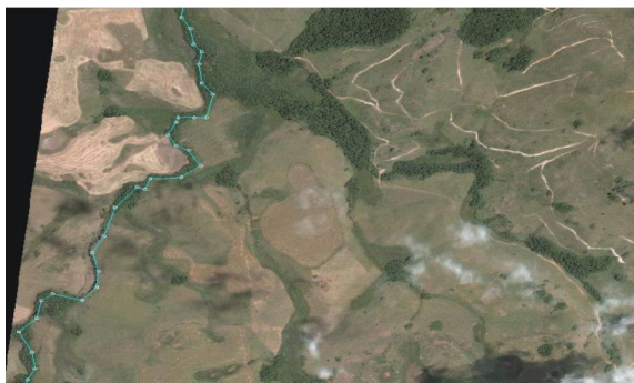
Figura 6 : Perímetro determinado com a união dos pontos levantados por GPS.
